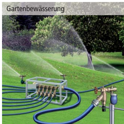
Anschluss einer Beregnungsanlage in öffentlichen Grünanlagen
